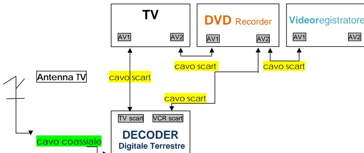
**OSS. 1.** È necessario usare un decoder digitale terrestre dotato di due prese SCART. Un buon dispositivo di ricezione del segnale è quello fabbricato dalla TELESYSTEM di Vicenza, p.es. TS6206 DT Zapper (o 6207 o superiore).
